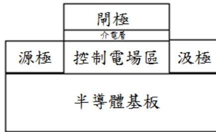
圖八、場效電晶體示意圖。
